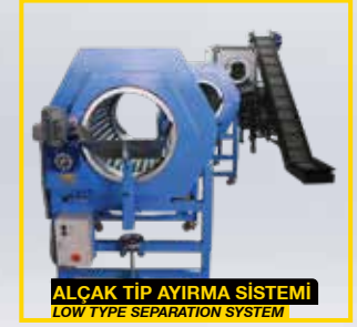
YOLLUK AYIRMA VE KONVEYÖR SİSTEMİ SEPARATION SYSTEM AND CONVEYOR
